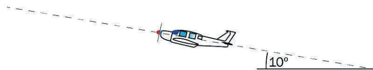
Luftmotstanden er 10 kN mot fartsretningen. Løftekraften fra vingene virker vinkelrett på fartsretningen. I tillegg til luftmotstanden og løftekraften er det to andre krefter som virker på flyet.
